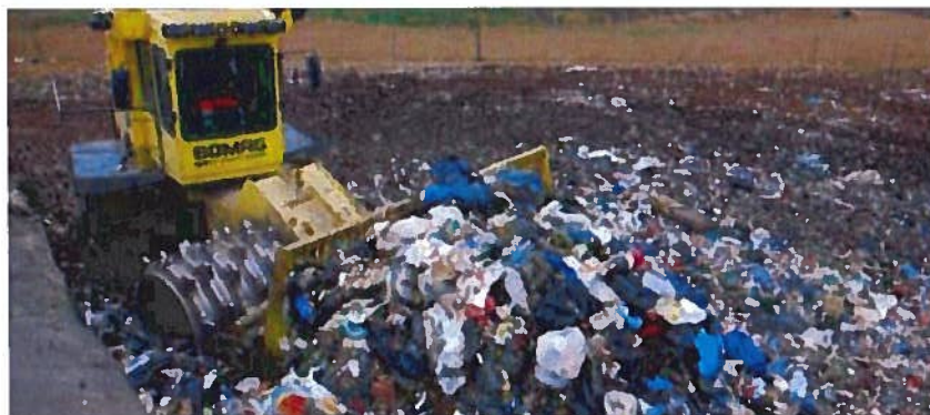
Figure 5 : Compaction des OMR* sur les casiers de stockage au SMET (Chagny)
