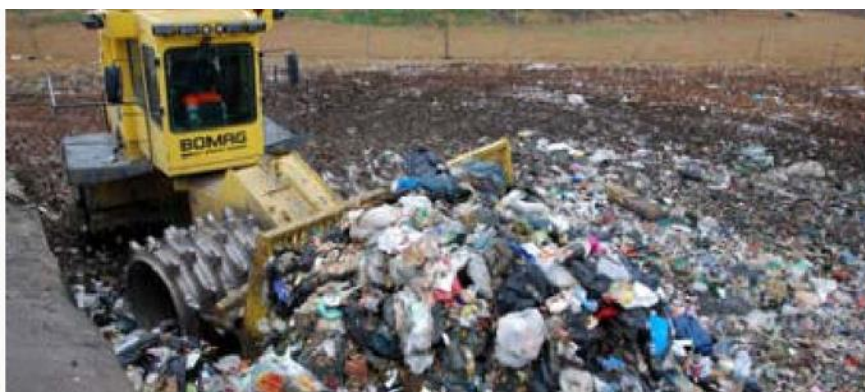
Figure 5 Compaction des OMR* sur l'ISDND de Chagny
