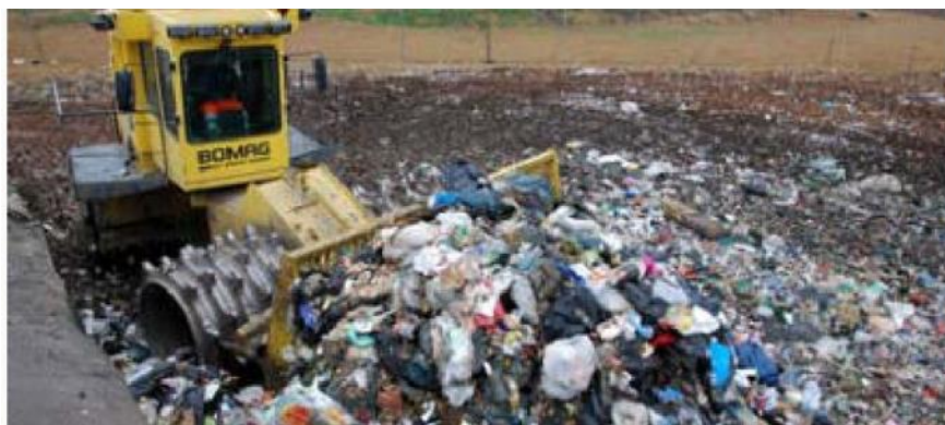
Figure 5 Compaction des OM * sur l'ISDND de Chagny
